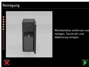
Abb.: Milchbehälter entfernen
