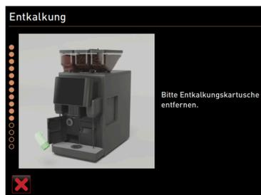
Abb.: Entkalkungskartusche entfernen
