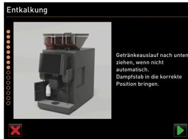
Abb.: Getränkeauslauf und Dampfstab positionieren
