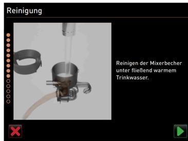
Abb.: Mixerbecher reinigen
