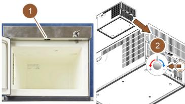
Abb.: Unterthekenkühleinheit einschalten und einstellen
