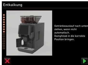
Abb.: Getränkeauslauf und Dampfstab positionieren
