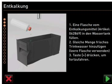
Abb.: Flüssigentkalker einfüllen
