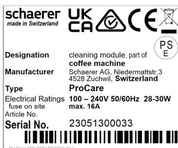
La plaque signalétique est située sur la face arrière de l'appareil.
