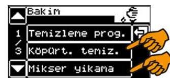
Köpürtücü temizliği ve karıştırıcıyı yıkama işlemleri ayrı olarak yapılabilir.
